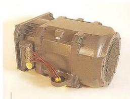
Moteur Euro-tram : moteur fermé, auto-ventilé, à refroidissement à air permettant un LCC réduit
