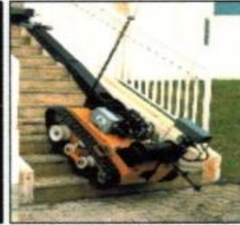
système de dépiégeage de colis suspects (30 unités produites)
