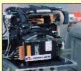
Imajeur laser TELEMA (précision de la mesure 1 mm à 50 kHz)
