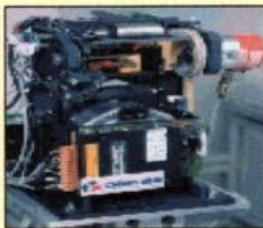
Imajeur laser TELEMA permettant de réaliser sous l'eau des images 3 D avec une précision < 1 mm
