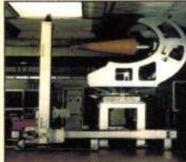
Système de positionnement 4 axes pour l'analyse et le contrôle des radomes d'avions en hyperfréquences radar (Direction des Constructions Aéronautiques)
