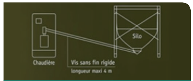
TRANSPORT DE GRANULES PAR VIS SANS FIN
